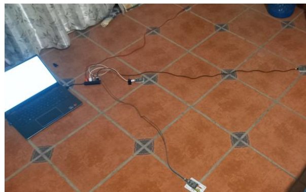
Figura 4 Esquema simplificado de la configuración del sistema de localización por Trilateración. Tres NodeMCU funcionan como Beacons de referencia y un NodeMCU como Beacon móvil a localizar.
