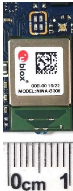
Figura.3 Módulo NINA-B306, el cual contiene un CPU ARM Cortex M4, bluetooth de baja energía con antena integrada y 1 MB de memoria flash para el programa, en un chip de 1 cm 2 .
