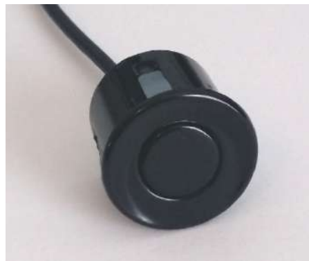
Figura.2 Sensor ultrasónico a prueba de agua, con emisor y detector de señal en un solo componente. Fuente: Imagen propia.
