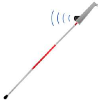
Figura.6 Prototipo de bastón con tecnología 4.0 para invidentes, con la capacidad de detectar objetos antes de que sean tocados.
