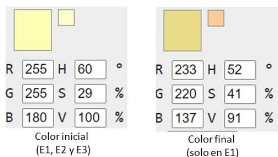
Figura 1. Modificaciones en la tonalidad de color en las muestras de polvo vegetal bajo la escala RGB en los tres tratamientos. E 1 : papel Kraft, E 2 : frasco de vidrio y E 3 : bolsa zipper. Fuente propia.
