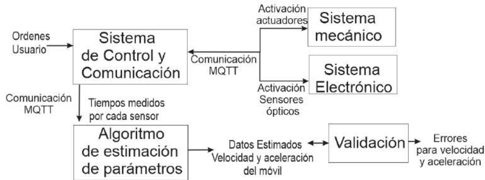
Figura 3. Metodología de diseño para el módulo LR.
